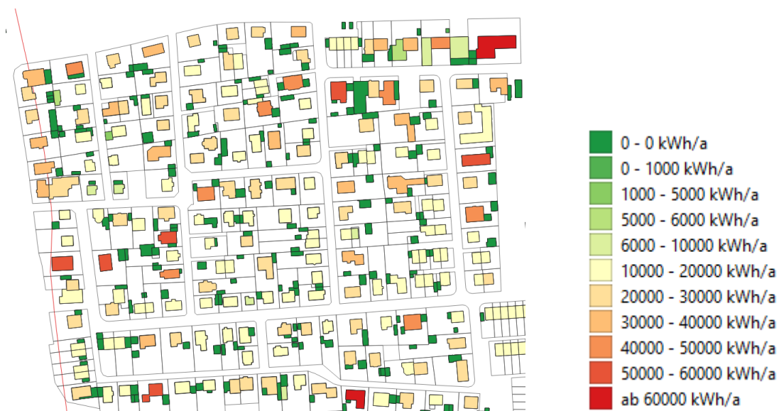
Abbildung 3: Exemplarischer Auszug des gebäudescharfen Wärmekatasters
